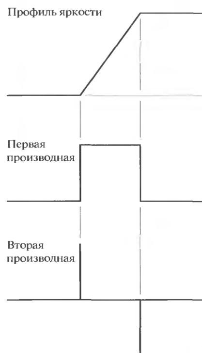
Рис. 4.2. Горизонтальный профиль яркости вблизи перепада яркости, а так же первая и вторая производные этой зависимости
